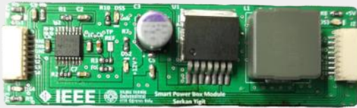
Fig 22 : Smart Power Box
