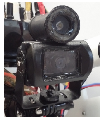
Fig. 9 Water proof for AV camera (credit: Panda)
